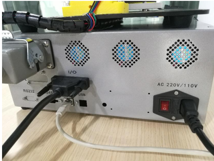
控制箱电源连接与开关实物图
