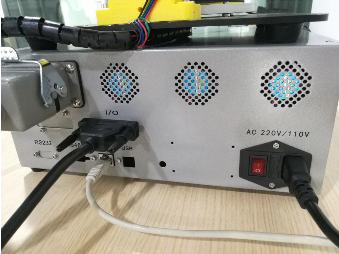
控制柜连线实物图
